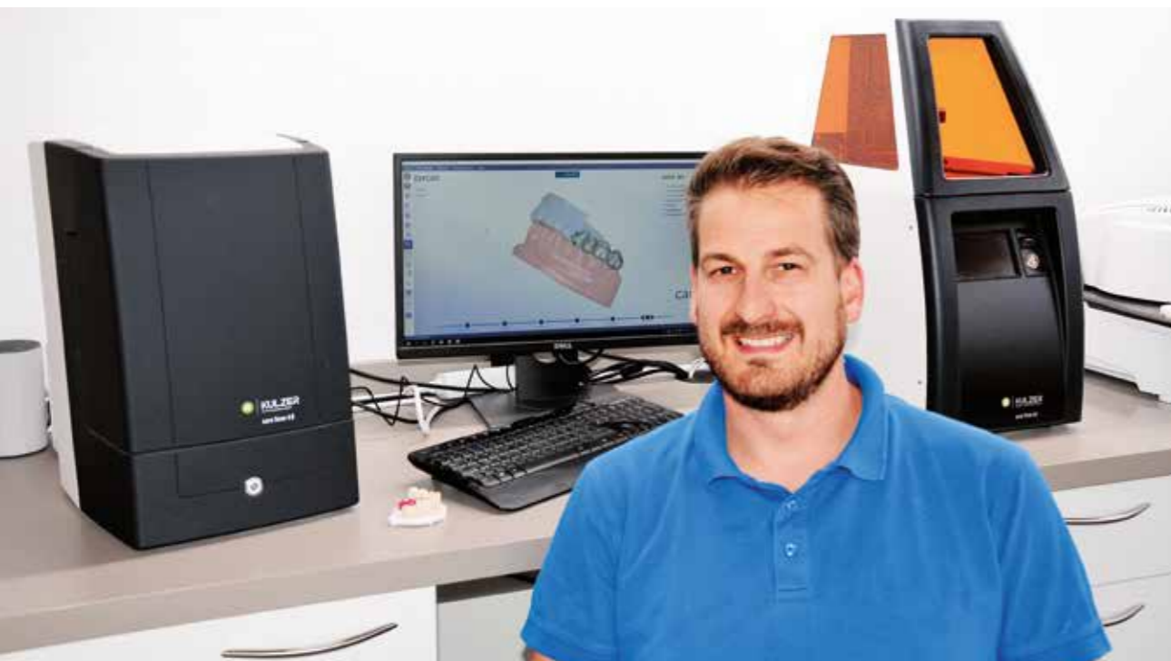
ZTM Manuel Gassner mit seiner kompakten CAD/CAM-Center, bestehend aus dem Scanner cara Scan 4.0 und dem 3D-Drucker cara Print 4.0
