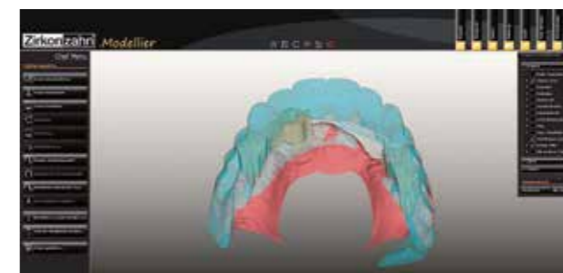
Abb. 4: Das neue Set-up wurde eingescannt und so Primär-, Sekundär- und Tertiärgerüst dimensionsgerecht designt
