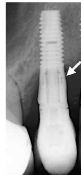
Abb. 2: Röntgenbild eines Implantats in Regio 15 zirka 3 Jahre nach Implantoplastik – der Pfeil zeigt den Bruch an der mesialen Seite des Implantats an
