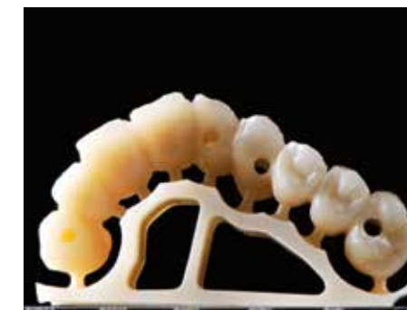
Abb. 6: Gerüst aus IPS e.max ZirCAD Prime nach dem Sintern.
