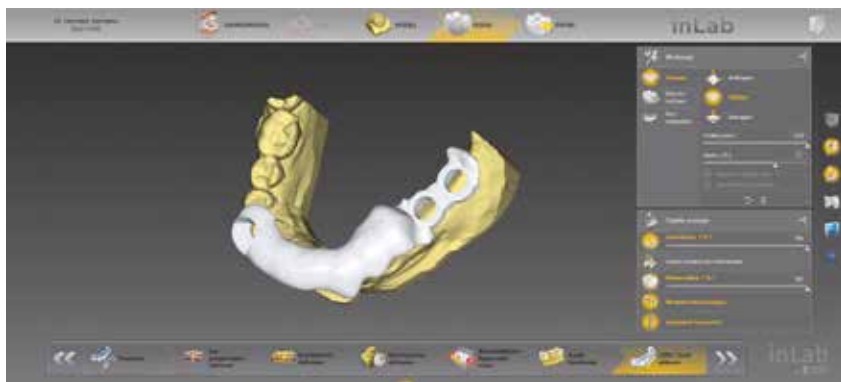
Abb. 2: CAD/CAM einer Cerec Guide 3 Bohrschablone auf Grundlage der digitalen Zielplanung.
