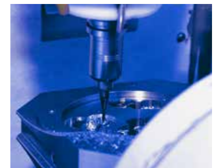
Für Implantatsgeometrien ist eine 5µ Präzisionsmaschine von Vorteil.
