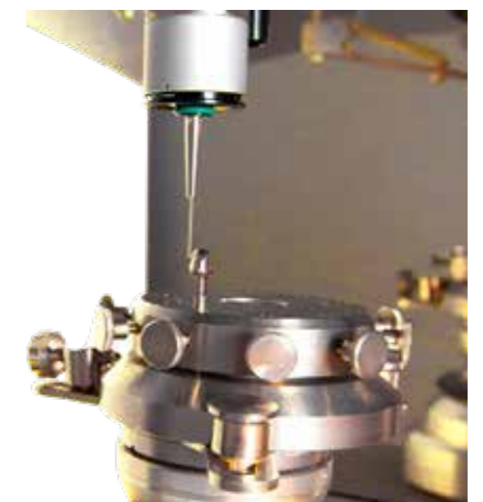
Taktile Scanner: Essentiell für eine gleichbleibende und einstellbare Friktion (wie z.B. für Teleskope).
