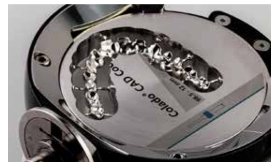
CoCr Gerüst mit Calado CAD, im dental System von 3shape auf verschraubbaren Sekundärteilen von Straumann mit Vario-base (MundART)
