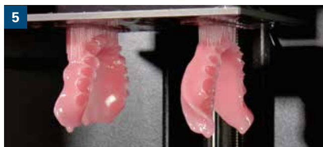
5 Die additiven Prothesenbasen kommen frisch aus dem 3D-Drucker.
