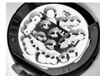
In einem Nesting und Fräs-Vorgang über Nacht problemlos mit dem Werkzeugwechsler und Automatik Modus die IPS Zir CAD Prime Ronde gefräst (MundART)
