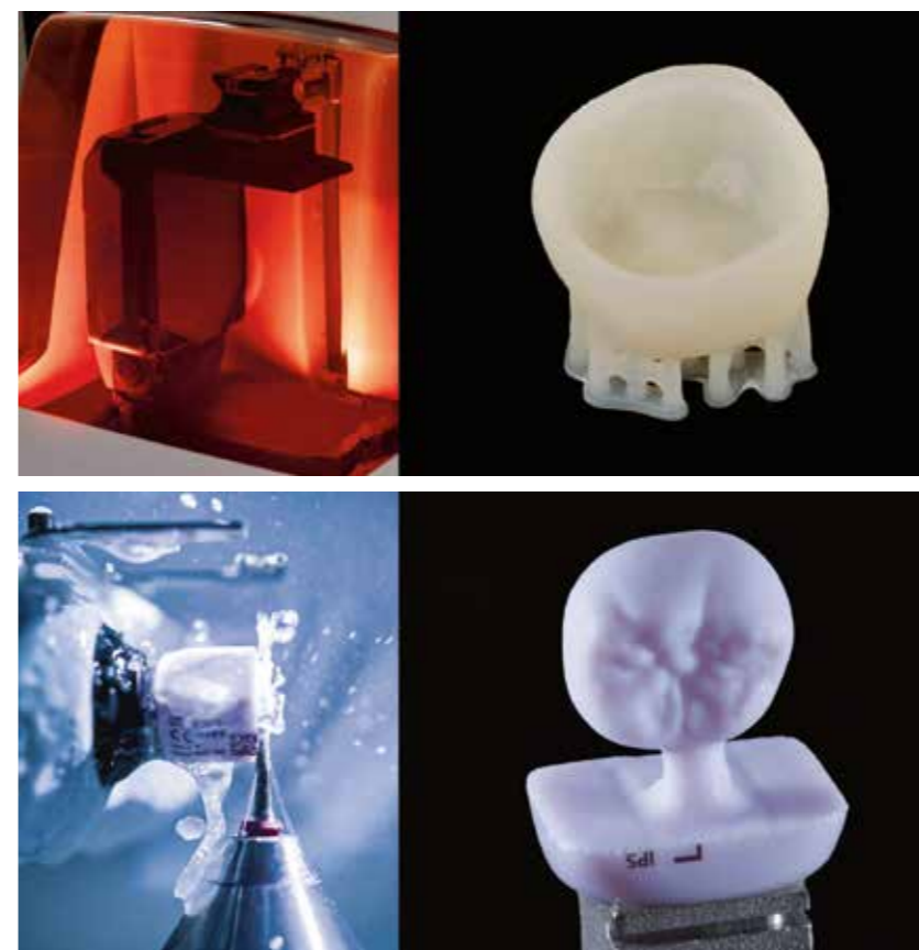
Basierend auf dem digitalen Datensatz (Intraoralscanner) werden zwei Kronen angefertigt. Eine Krone wird mit ProArt Print Wax gedruckt und anschliessend gepresst, die andere Krone als Vergleichsobjekt im CAD/CAM-Fräsgesetz aus dem Block ausgeschliffen.
