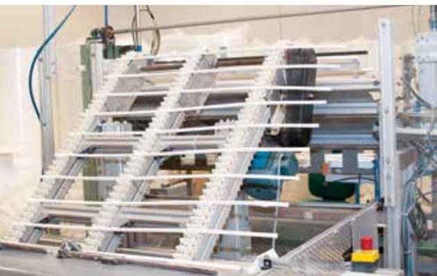
Transport der Watterollen-Stangen zur Verpackungsanlage
