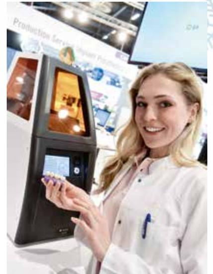
Zahnersatz aus dem Drucker – hier im DLP-Verfahren („Digital Light Processing“)
