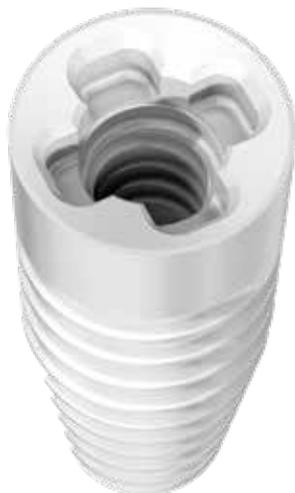
*Die leicht abgeschrägte Kontaktfläche der Implantatplattform erleichtert die Zentrierung der prothetischen Komponenten, während vier Arretierungen im Implantat für einen Rotationschutz des Abutments sorgen. Die Arretierungen werden nicht belastet*
