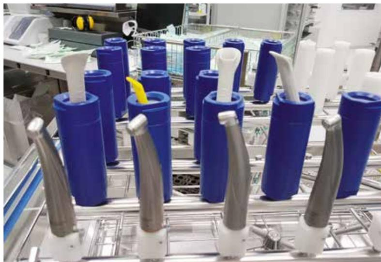
Hohlkörper wie etwa Absaugkanülen oder Winkelstücke müssen während des Reinigungs- und Desinfektionsvorgangs durchgespült werden. Daher werden sie auf speziell passende Adapter aufgesteckt. Dabei werden die Kanäle der Hohlkörper wie beim Gebrauch am Patienten durchgespült.
