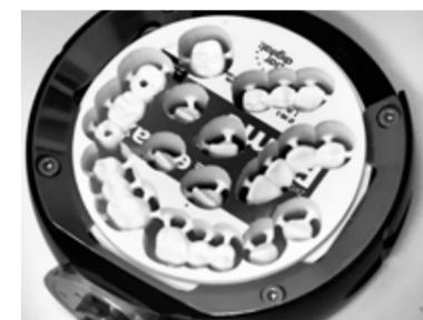
In einem Nesting und Fräs-Vorgang über Nacht problemlos mit dem Werkzeugwechsler und Automatik Modus die IPS Zir CAD Prime Ronde gefräst (MundART)
