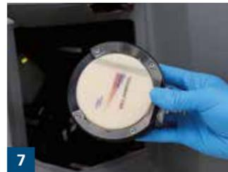
7 Einspannen der SR Vivodent CAD Multi-Disc mit der Beschriftung nach oben
