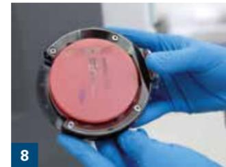
8 Einspannen der IvoBase CAD-Disc für die Prothesenbasis
