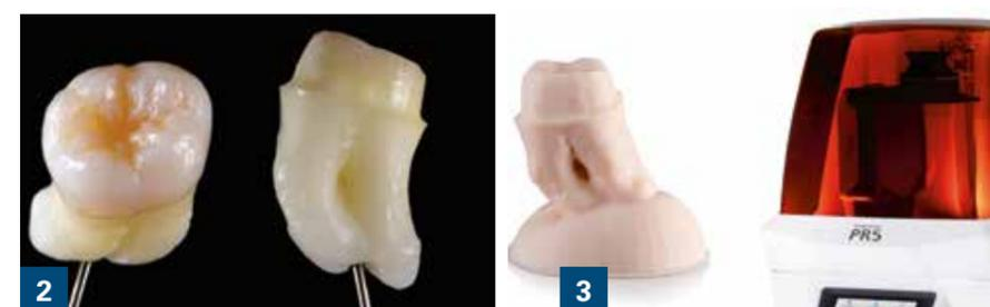
Abb. 2 und 3 Ein natürlicher Zahn dient als Vorlage (simulierte In-vivo-Situation) für die laborinterne Untersuchung. Mit dem 3D-Drucksystem Progra-Print wird das Kontrollmodell gedruckt.
