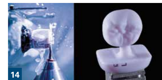
Abb. 14 Schleifen der Krone (IPS e.max CAD) im CAD/CAM-Fräsergerät (PrograMill One).
