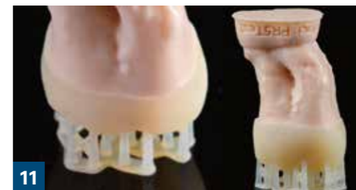
Abb. 11 In ausbrennbarem Wachsmaterial (ProArt Print Wax) gedruckte Krone auf dem gedruckten Modell (3D-Drucksystem PrograPrint).
