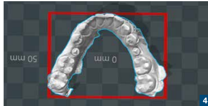
Das virtuelle Modell des Unterkiefers war die Grundlage für die additive Fertigung eines Kontrollmodells.
