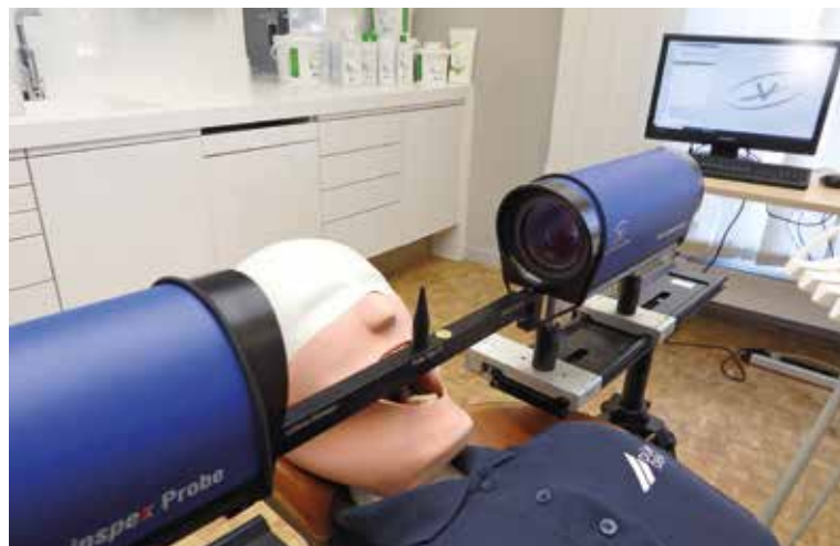
Die hochsensible Kamera wird normalerweise für die Strömungsmesstechnik, Verbrennungs-, Spray- und Partikelanalyse verwendet, Dr. Martin Koch verwendete diese jedoch um kleinste Partikel zu messen, die aus der Mundhöhle herausgeschleudert werden.
