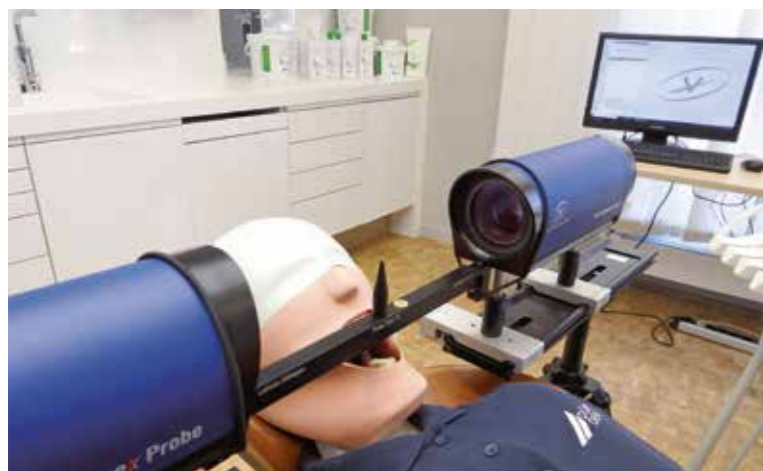
Die hochsensible Kamera wird normalerweise für die Strömungsmesstechnik, Verbrennungs-, Spray- und Partikelanalyse verwendet, Dr. Martin Koch verwendete diese jedoch um kleinste Partikel zu messen, die aus der Mundhöhle herausgeschleudert werden.
