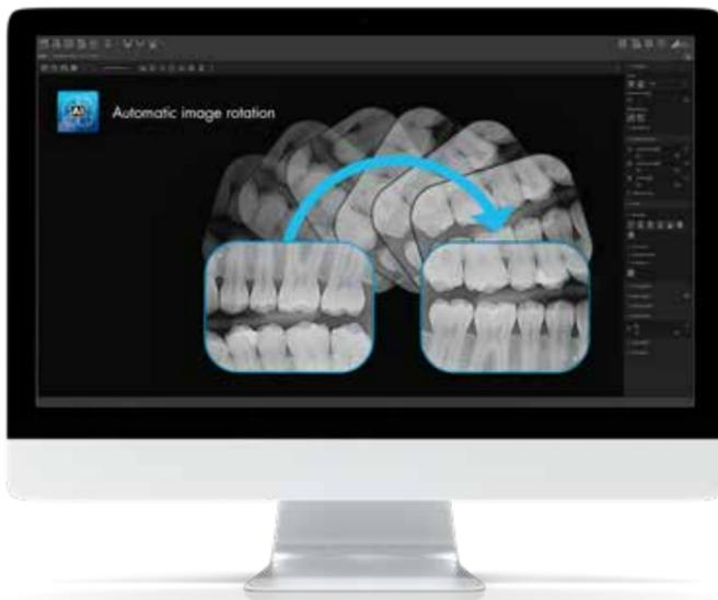
Ein auf künstlicher Intelligenz basierender Algorithmus der Imaging Software prüft die Orientierung intraoraler Röntgenbilder anhand der dargestellten Anatomie und korrigiert bei Bedarf automatisch die Bildrotation.
