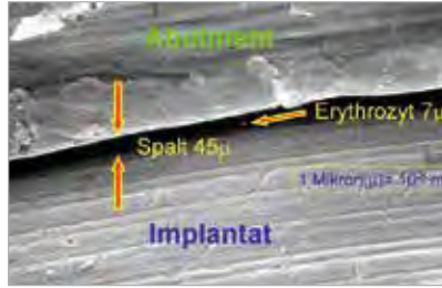
Spalt zwischen Abutment und Implantat
