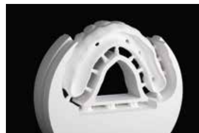
Abb. 6: Die Sekundärstruktur aus Zirkonoxid wurde aus einer 25 mm grossen Ronde Initial Zirconia Disk Multilayer Elite (GC) gefräst.
