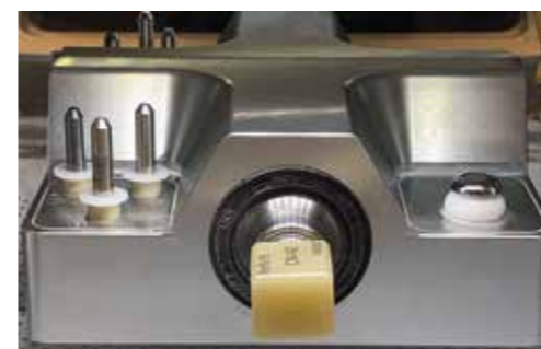
Abb. 4: Der Werkzeugwechsel erfolgt mittels pneumatischen Spannsystems, die Länge der Werkzeuge wird automatisch am Tastknopf (rechts im Bild) vermessen.
