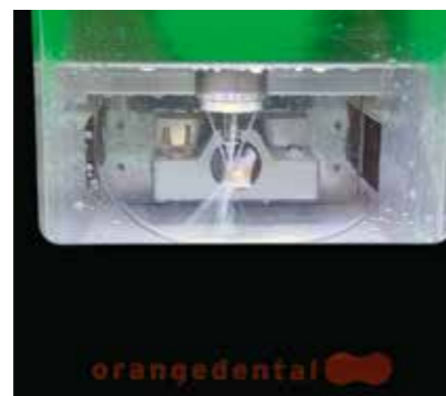
Abb. 1 und 2: Die neue kompakte EASYMill 4 Schleifeinheit von orangedental (Biberach) arbeitet mit Wasserkühlung
