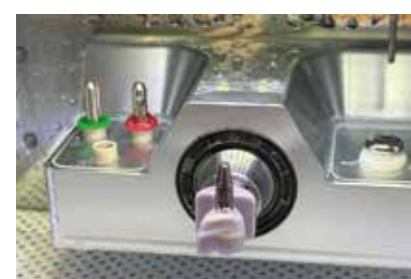
Abb. 33 bis 35: CNC-Fertigung einer Hybrid-Abutmentkrone aus Lithium-Disilikat (IPS e.max CAD)
