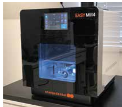
Abb. 1 und 2: Die neue kompakte EASYMill 4 Schleifeinheit von orangedental (Biberach) arbeitet mit Wasserkühlung
